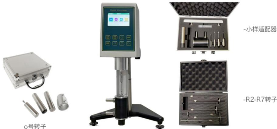
\* 注：0号转子为选配件，可测低粘度0.1mPa.s。专用于测量低粘度的样品，样品量仅需25ml；圆柱体转子可以准确计算剪切率；便于详细分析产品。
